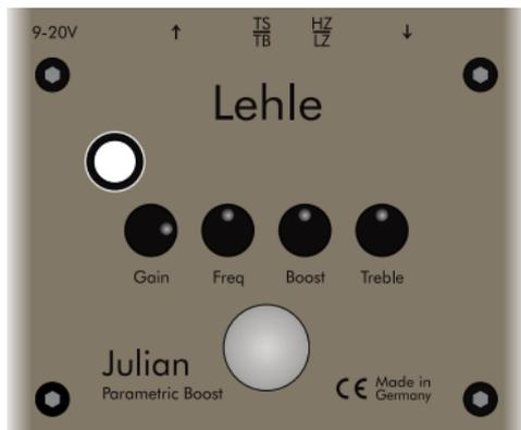
Wenn die Regler Freq, Boost und Treble in der Mittelstellung sind, überträgt der **Lehle Julian** den Ton des Instruments clean, ohne den Frequenzgang oder die Dynamik zu beeinflussen. Wenn
